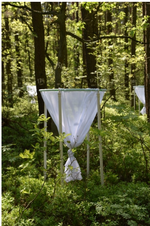
Rysunek 87. Kolektory opadu ścióły w drzewostanie sosnowym z domieszką gatunków liściastych w Nadleśnictwie Chojnów
